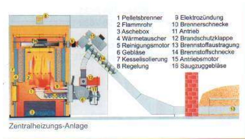
Bild 3: Pellet-Zentralheizungsanlage Quelle: German Pellets, Wismar
