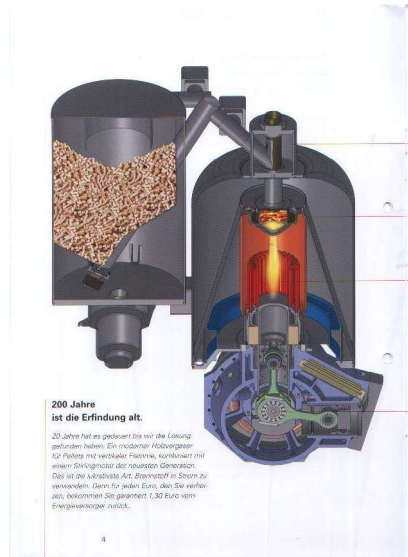
Bild 5:Funktionsquerschnitt der Sunmaschine 2005 Quelle: Sunmaschine Vertriebsgesellschaft GmbH
